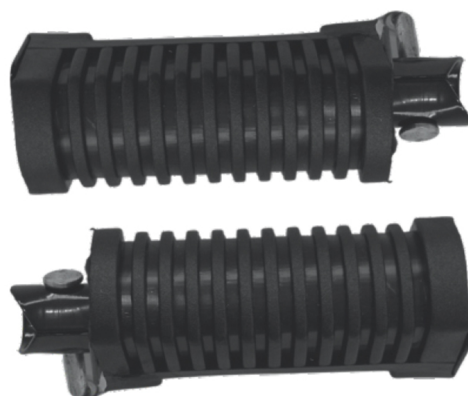
CÓD. 0023 Traseira Direita CÓD. 0024 Traseira Esquerda TITAN 125 ES 00/04 TITAN 150 08/10 /BROSS TITAN 150 KS 04/08 Modelo produzido em Ferro
