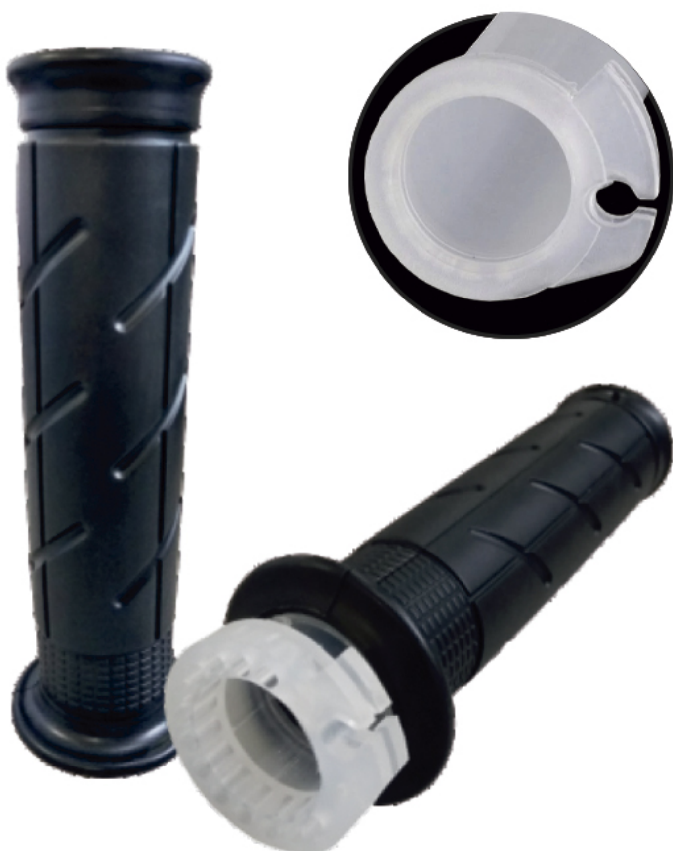
CÓD. 0097 PT Manopla com Roldana TITAN 00 e TITAN 150
