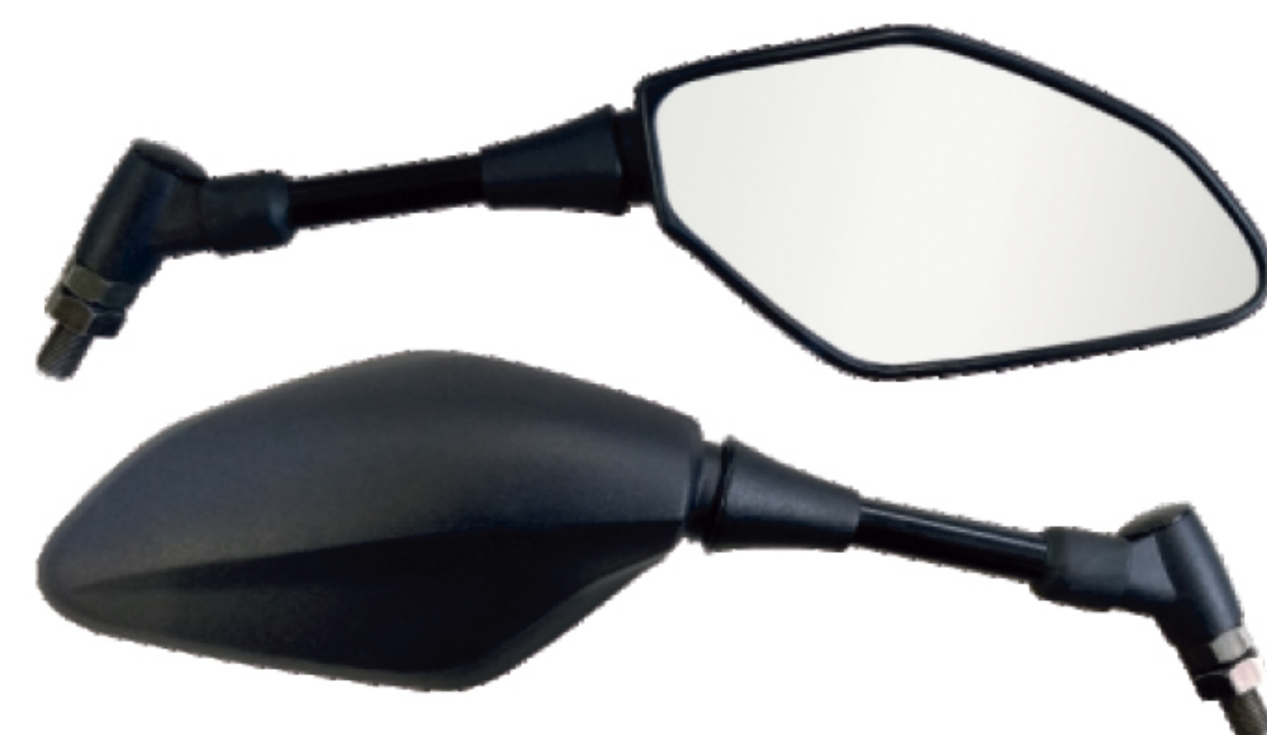
CÓD. 652 Rosca Honda CÓD. 653 Rosca Yamaha MT 03/07/09 Rotativo com Ajuste de Torque
